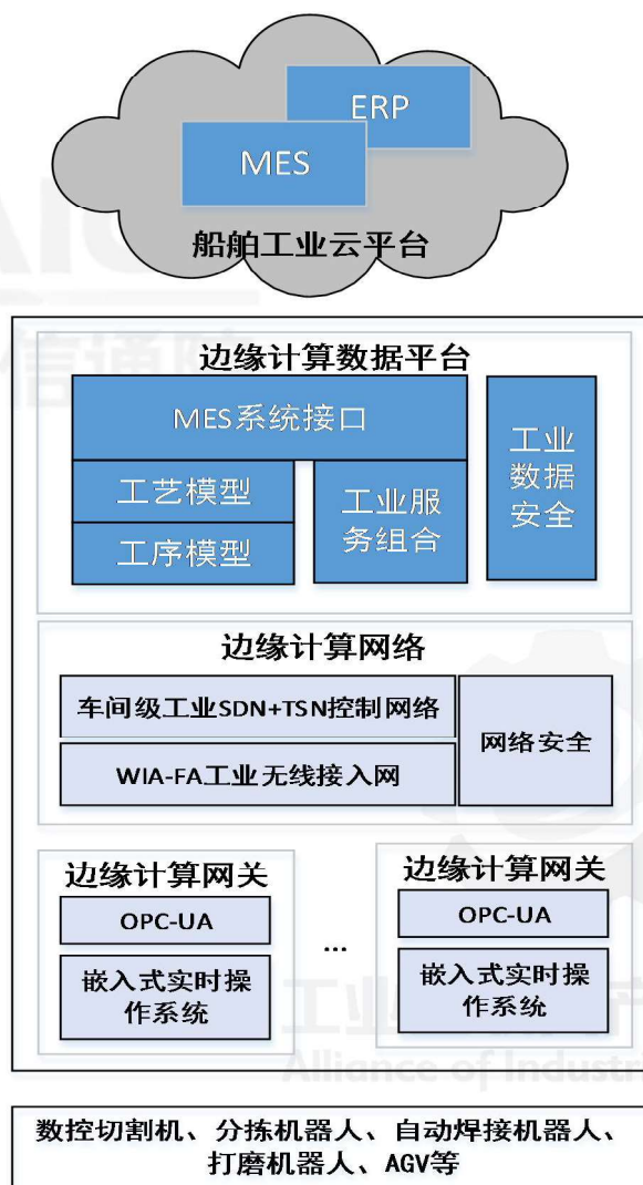
图6 船舶舾装件制造行业个性化定制和自组织生产系统框架
