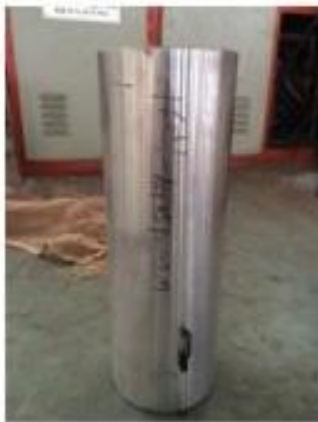
石墨烯铝基复合材料锭坯（7个批次）
