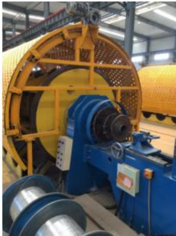
石墨烯铝导线绞合设备
