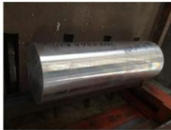
石墨烯铝基复合材料锭坯（7个批次）
