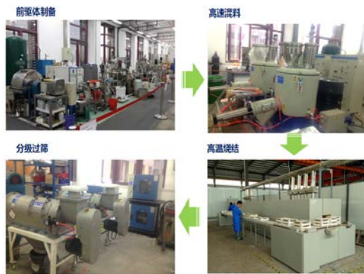
2013-2015年，在中科院先导专项支持下建立新一代动力锂电池石墨烯复合电极材料产中试实验线
