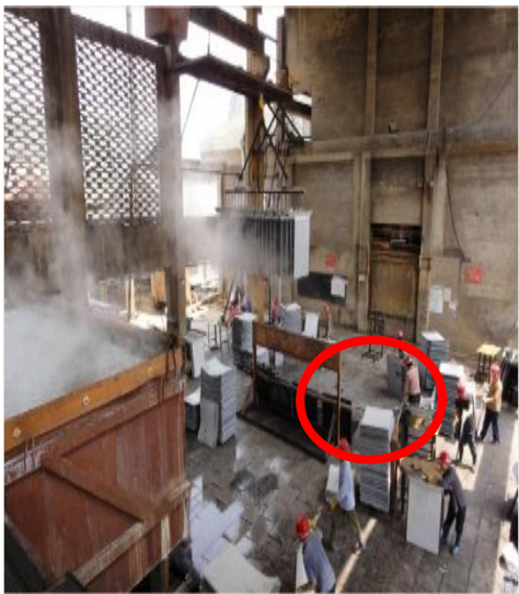
4米高空溅落 废水空中淋落、地面横流
