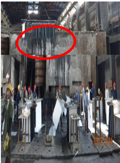
4米高空溅落 废水空中淋落、地面横流
