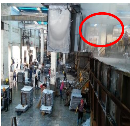
4米高空溅落 废水空中淋落、地面横流
