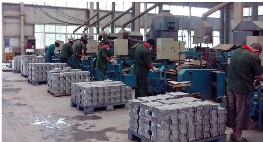
国内铅蓄电池制造企业普遍采用重力浇铸工艺进行板栅制造，该工艺装备生产效率低下、耗能高、污染物排放量大。
