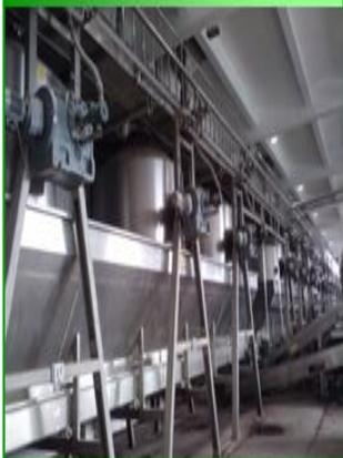
标准化的蒸粮工艺，程序自动控制，确保蒸粮的稳定性；高压保压蒸粮，大大减少蒸汽用量。
