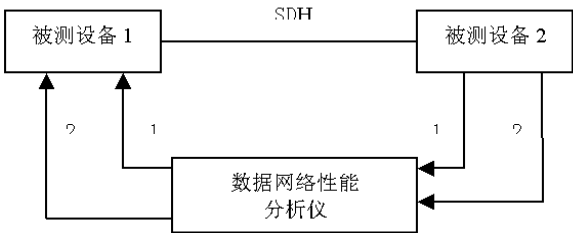
图 4. 3. 1-3 用户安全隔离测试连接示意图
