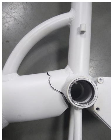
图 6 ISO 车架疲劳断裂情况
