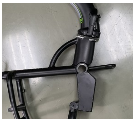
图 7 车架振动断裂情况
