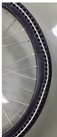
图 4 脱圈测试效果
