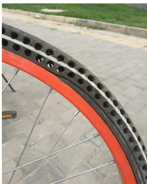
图 1 市场上免充气轮胎脱圈
