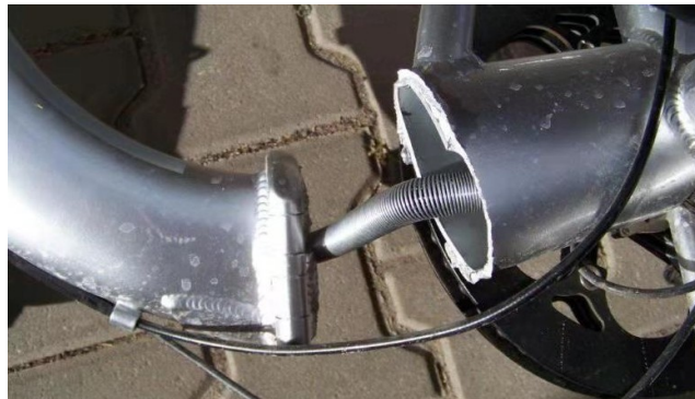
图 5 某公司折叠车市场断裂情况
