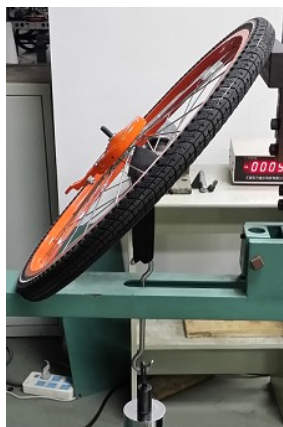
图 3 倾斜脱圈的试验方法
