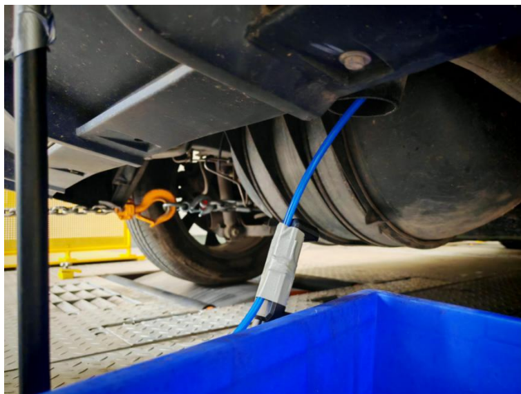
图3 测量点位置:位于排气管内几何中心线上
