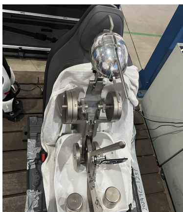
图 3 头枕高度测量
