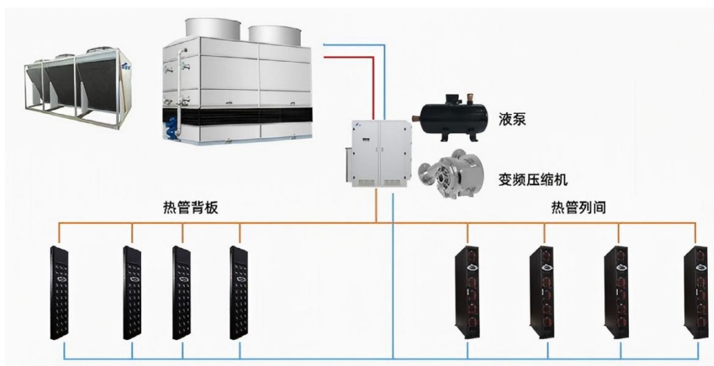
图 6: 昆山博浩 5G 大数据创新中心蒸发冷复合多联空调解决方案架构
