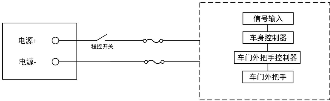
图 7 程控开关接入示意图
