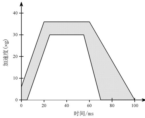
图 8 滑车加速度波形通道图
