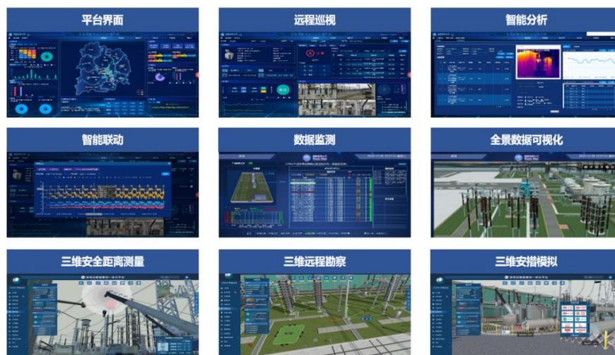
附图 1-2 变电智能运检云平台界面
