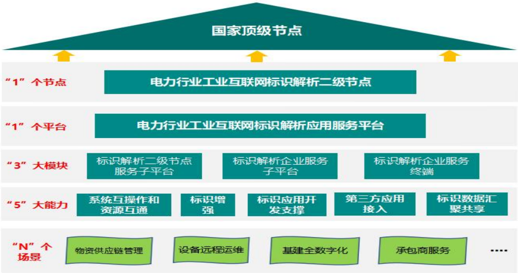
附图 1-12 电力工业互联网标识解析二级节点架构
