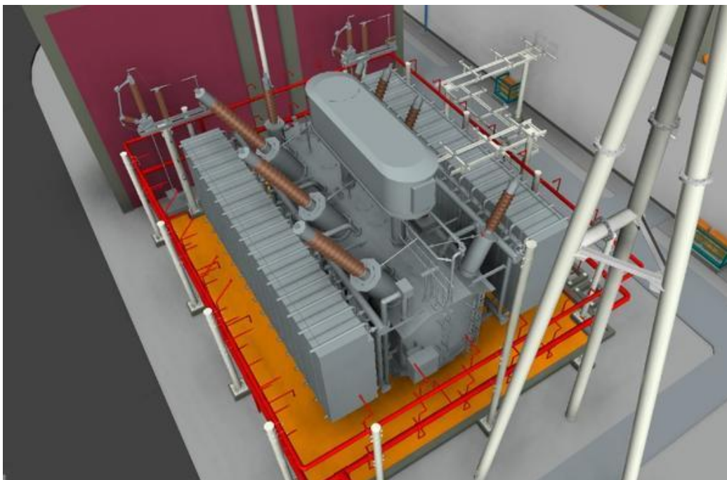
图 3-2 主变压器三维模型
