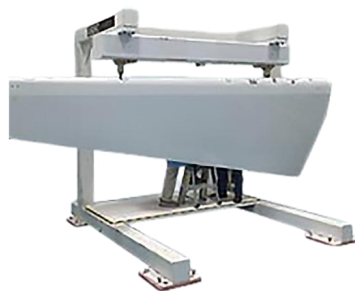
图 4 飞机舵面转动惯量检测设备
