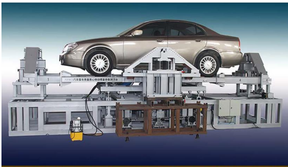
图 2 整车质量、质心、转动惯量综合测试台
