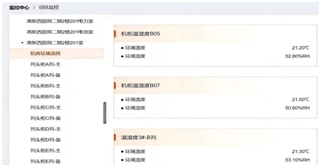
图 2：中国电信四川公司西信二期数据中心末端机柜温湿度监控系统
