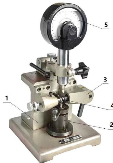
1—主机基座 2—加载机构 3—定位夹持机构 4—被测轴承 5—指示计
