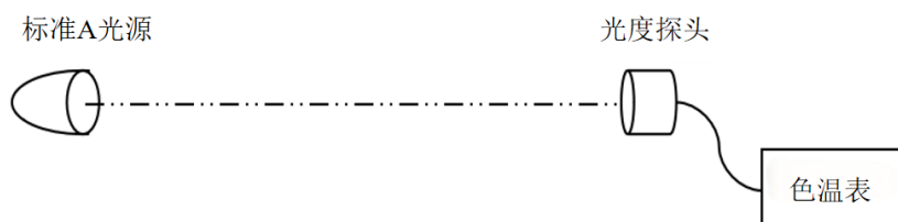
图5 标准 A 光源色温测量示意图
