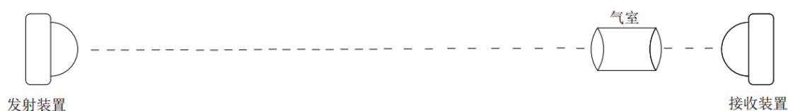
图 1 线型光束可燃气体探测器工作原理图
