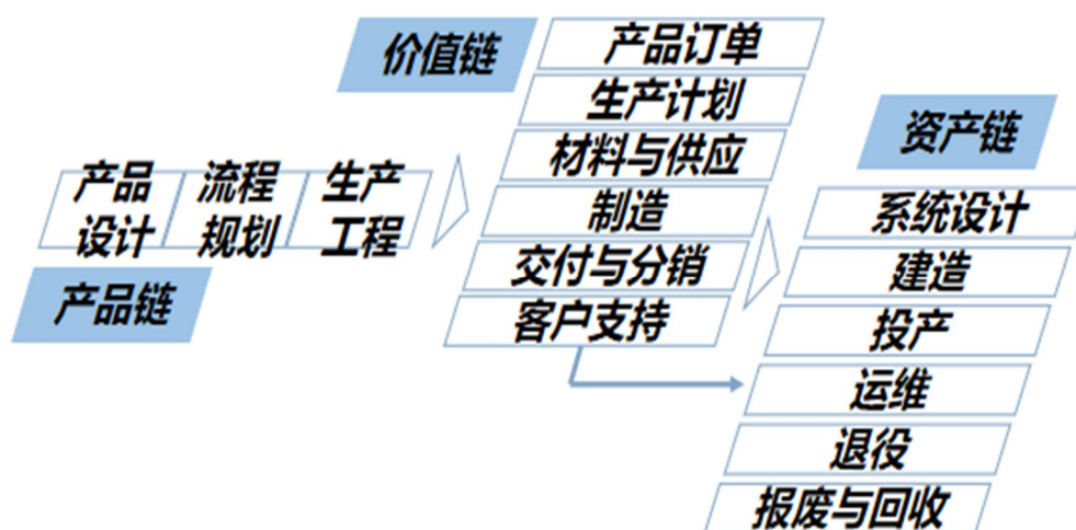
图 6 工业互联网业务视图应用层架构
