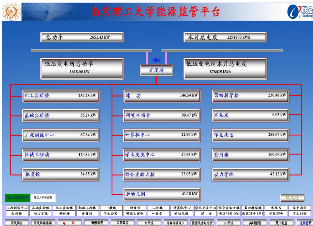
南京理工大学节能监管平台低压变电所监控界面
