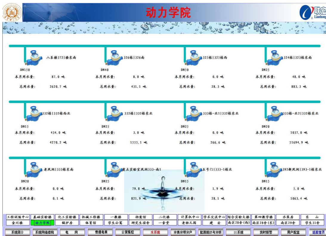
南京理工大学节能监管平台建筑水表监控界面
