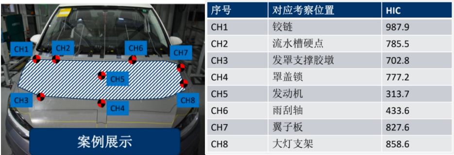
图 14 某款 MPV 车型试验结果
