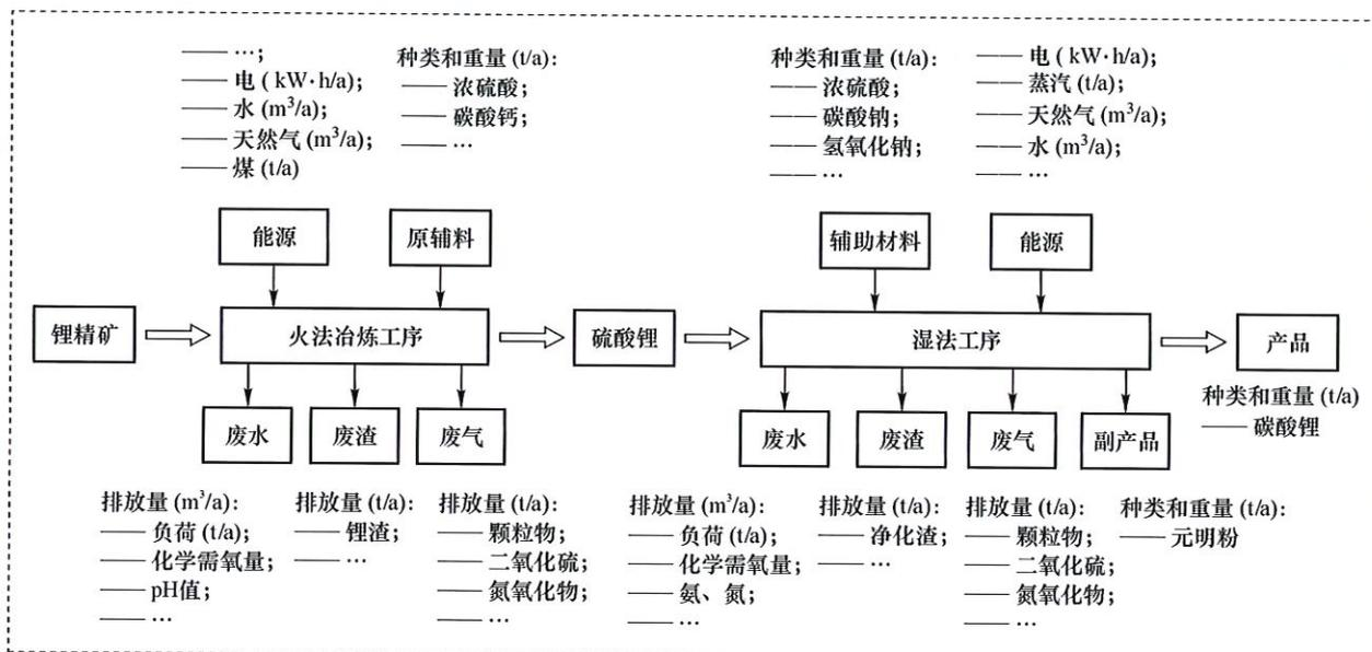
图 B.1 碳酸锂产品工序图
