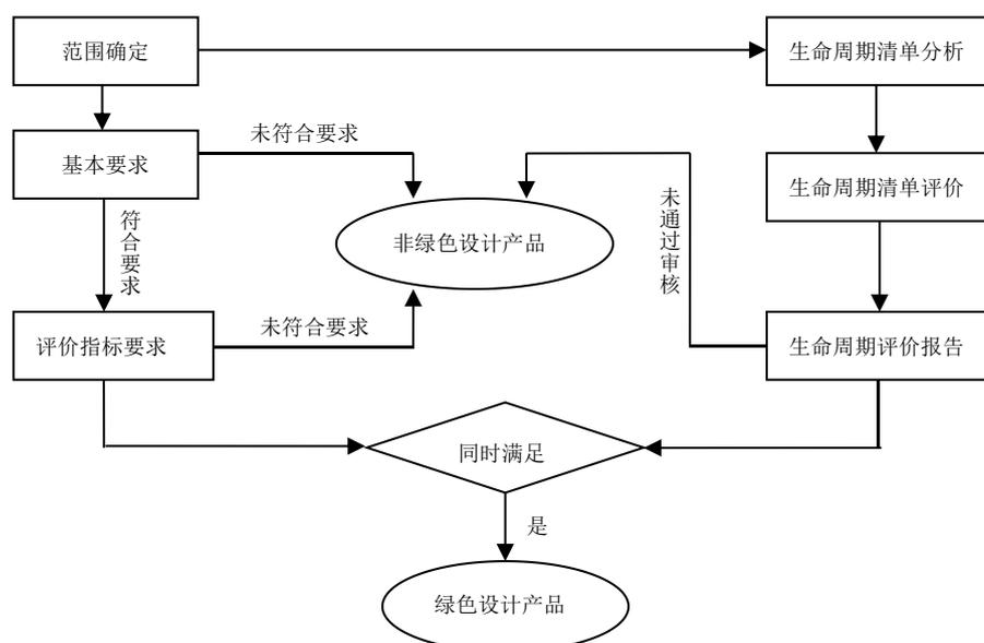
图 1 液体分散染料绿色设计产品评价流程
