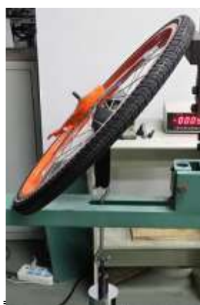
图 3 倾斜脱圈的试验方法
