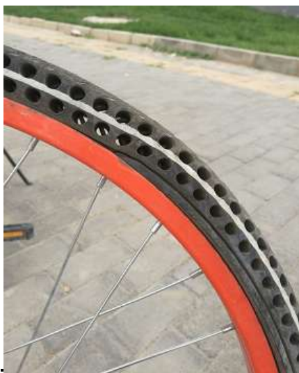
图 1 市场上免充气轮胎脱圈
