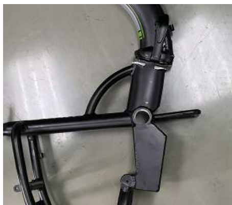
图 7 车架振动断裂情况
