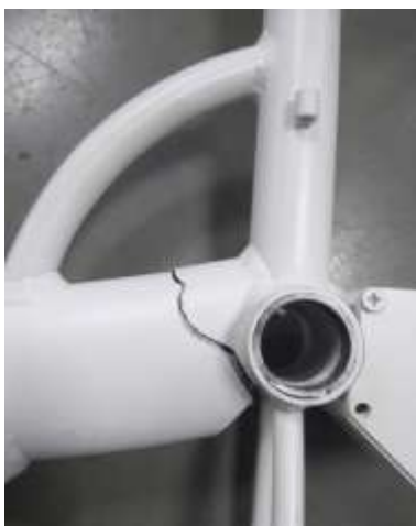
图 6 ISO 车架疲劳断裂情况
