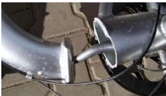
图 5 某公司折叠车市场断裂情况
