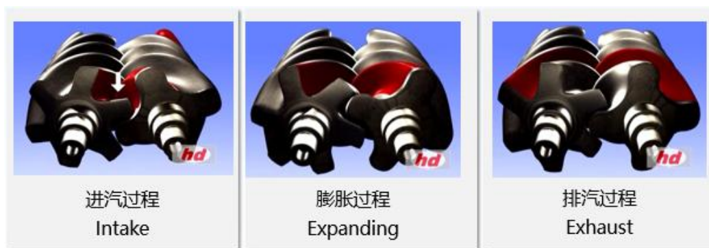
图 8 基于螺杆膨胀机的余热利用技术原理图
