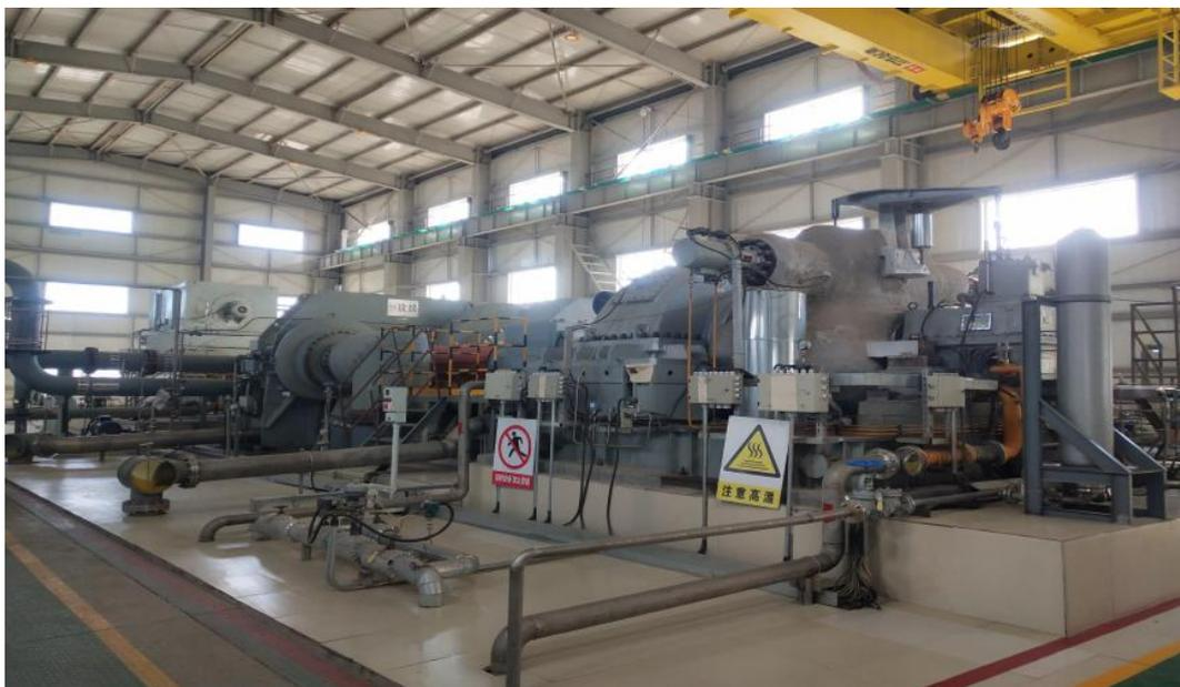
蒸汽拖动深冷制氧压缩机
