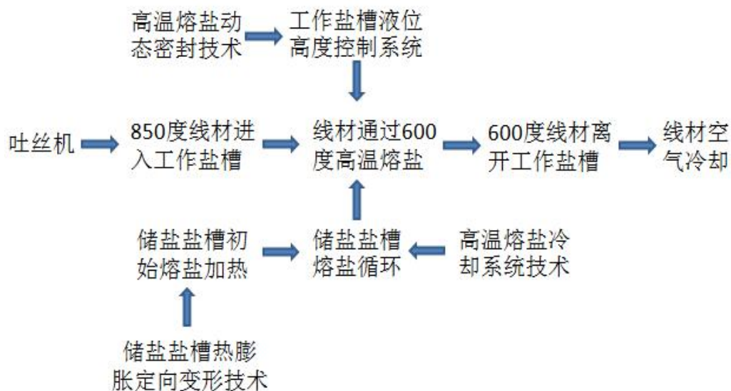
图 6 钢丝用线材在线盐浴热处理工艺流程图
