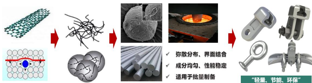
图 5 铝合金电力金具工艺流程图
