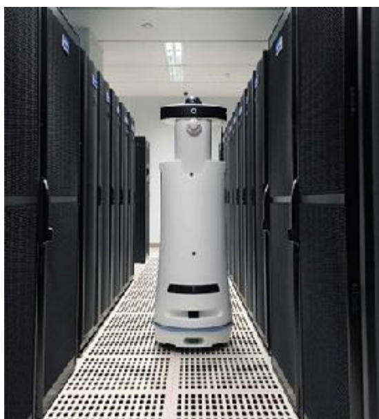
图 10 机器人自动化采集示意图
