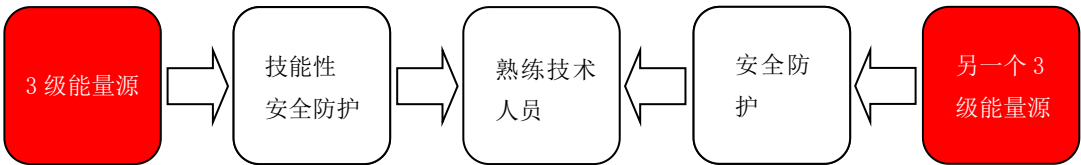
图 19 在设备维修状态期间防止 3 级能量源伤害熟练技术人员的保护模型
