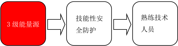
图 18 防止 3 级能量源伤害熟练技术人员的保护模型
