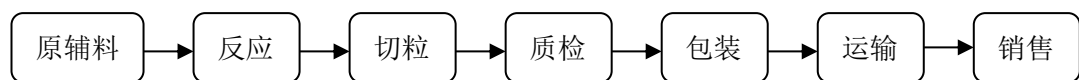
图 B.1 聚对苯二甲酸丁二醇酯 (PBT) 树脂产品生命周期系统边界图
