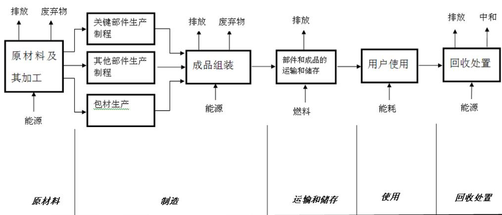
图A.1 盘管蒸汽发生器生命周期系统边界图
