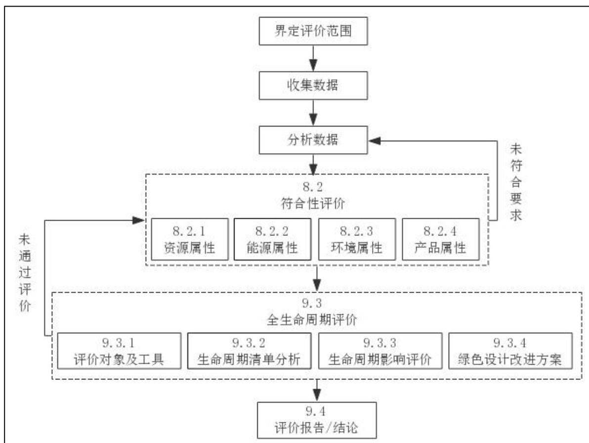
图 1 铸造用消失模涂料绿色设计评价流程
