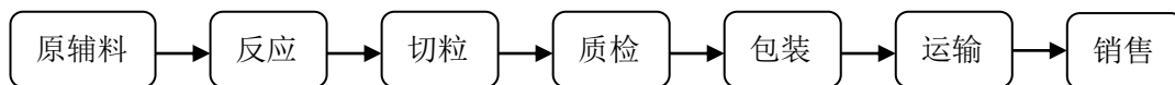
图 B.1 聚对苯二甲酸乙二醇酯(PET)树脂产品生命周期系统边界图
